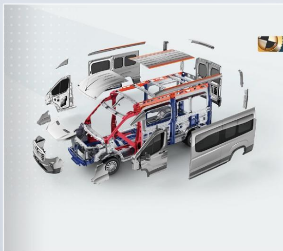
Struttura del corpo a gabbia + 61% di acciaio ad alta resistenza
