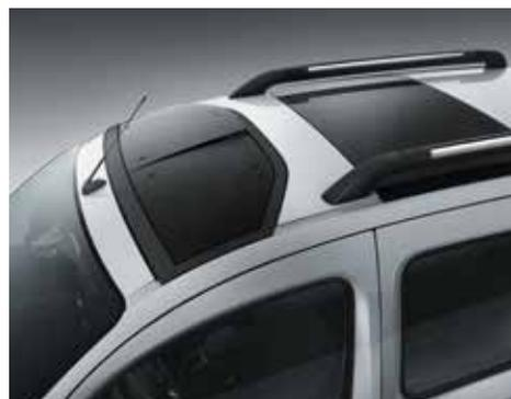
○ **Tetto panoramico.** Il tetto panoramico e i due finestrini<sup>5</sup> ribaltabili sul tetto assicurano una gradevole sensazione di spaziosità, grazie al rapido adattamento della climatizzazione interna e all'aumento della quantità di luce nell'abitacolo.
