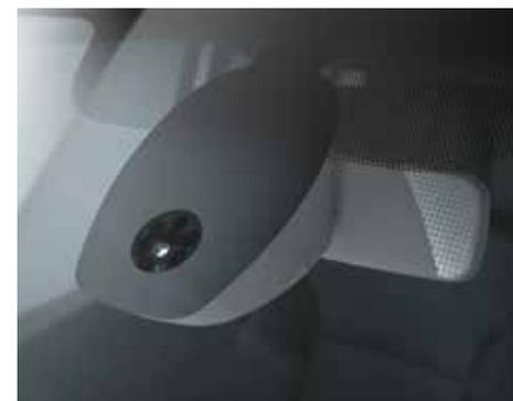
○ **Sensore luci e pioggia.** Il sensore luci e pioggia adatta automaticamente l'illuminazione e la velocità di funzionamento del tergicristallo alle condizioni di luce esterne o alle condizioni atmosferiche.
