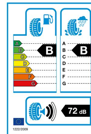
Dati secondo il Regolamento UE 1222/2009. L'etichettatura degli pneumatici fornisce indicazioni relative alle tre caratteristiche determinanti delle prestazioni degli pneumatici.
