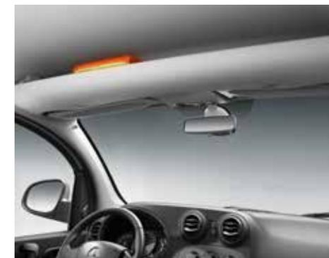
● **Ripiano sopra il parabrezza.** Il vano aperto sopra il parabrezza per lato guida e passeggero offre un volume di stivaggio di 12,6 litri.
