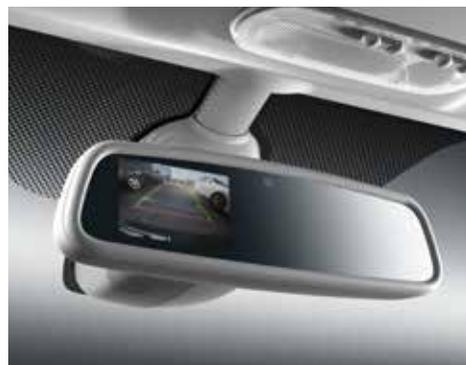
○ **Telecamera per la retromarcia assistita.** La telecamera con display nel retrovisore interno consente di visualizzare la zona retrostante il veicolo e, con l'ausilio di linee di riferimento statiche, supporta il guidatore nelle situazioni di parcheggio e manovra in spazi angusti.
