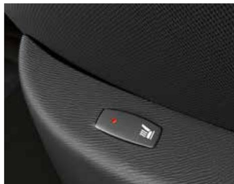
○ **Riscaldamento dei sedili anteriori<sup>1</sup>.** Il riscaldamento dei sedili viene ridotto automaticamente dopo 5 o 15 minuti.
