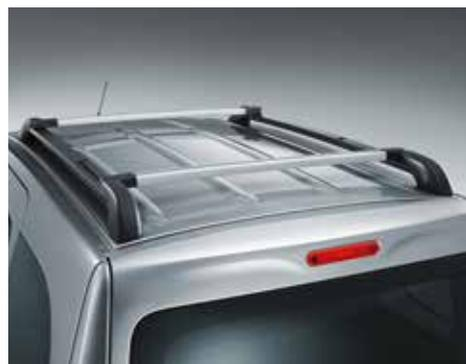
○ **Mancorrenti con supporto di base integrato.** I mancorrenti possono essere utilizzati come supporto per il tetto posizionando trasversalmente le barre; la capacità di stivaggio può essere aumentata aggiungendo un box per il tetto.
