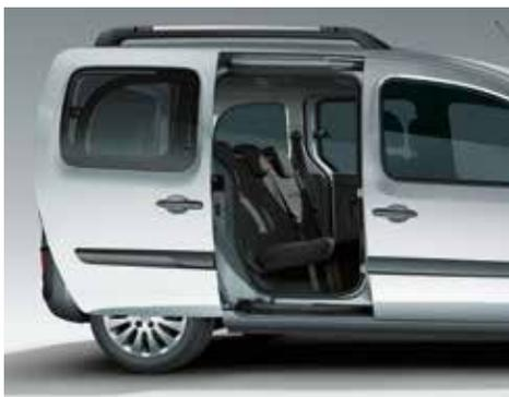
● **Porta scorrevole destra con deflettore.** La porta scorrevole sul lato destro è dotata di apertura della porta Comfort, finestra di ventilazione e ampio gradino per un accesso più comodo.
