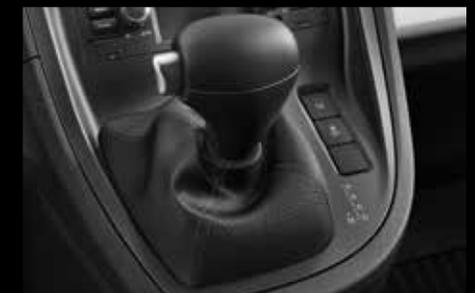
Il cambio a doppia frizione 6G-DCT<sup>1</sup> unisce il comfort di un cambio automatico a 6 marce alla dinamica di marcia del cambio manuale.
