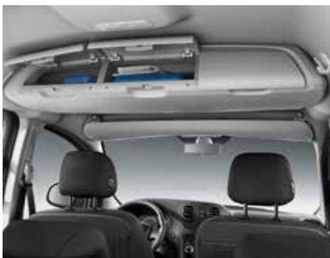
○ **Vano portaoggetti superiore nel vano passeggeri<sup>1</sup>.** Tre pratici e sicuri scomparti di pari dimensioni, per una capacità totale di 24,4 litri, offrono ulteriore spazio di stivaggio per gli oggetti.
