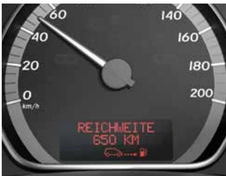
○ **Computer di bordo.<sup>2</sup>** Il computer di bordo mostra in un colpo d'occhio consumi di carburante, distanze, autonomia o velocità media.
