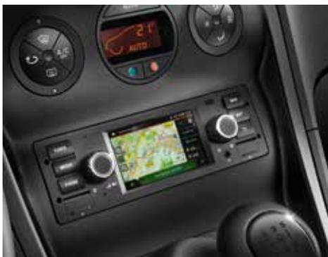
○ **Sistema di navigazione con autoradio inclusa.** Il sistema con display touchscreen integrato e radio digitale DAB+ è incorporato nella consolle centrale. Con Bluetooth®, porta USB e collegamento Aux-in, lettore di schede Micro SD.
