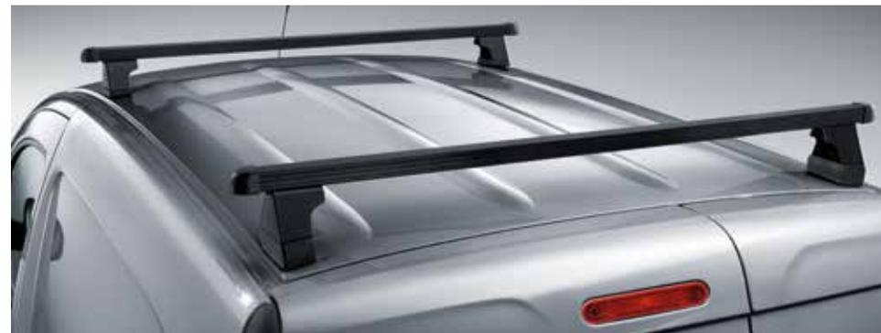
**Supporti di base per il tetto standard, due barre d'appoggio trasversali<sup>1</sup>.** Il robusto profilo quadrangolare costituisce la base per diversi supporti. Si avvita agli appositi punti di fissaggio presenti sulla canalina del tetto.
