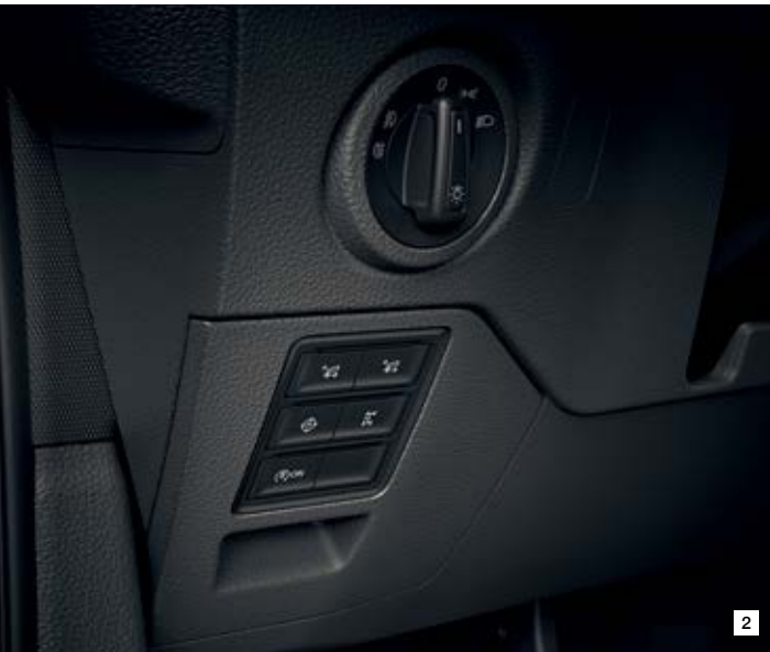
1 – Furgone Plus (disponibile in diverse altezze e lunghezze); 2 – Pannello di controllo separato per la gestione dell'allestimento, azionabile dal posto di guida o all'esterno del veicolo; 3 – Carro attrezzi
