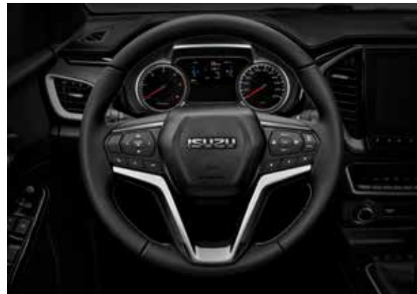
Servosterzo Elettrico. L'assistenza alla sterzata è migliore in tutte le condizioni di guida: alle basse velocità (sterzo più leggero) ed alle alte velocità (sterzo più duro), incrementando di conseguenza il comfort e la sicurezza di guida.
